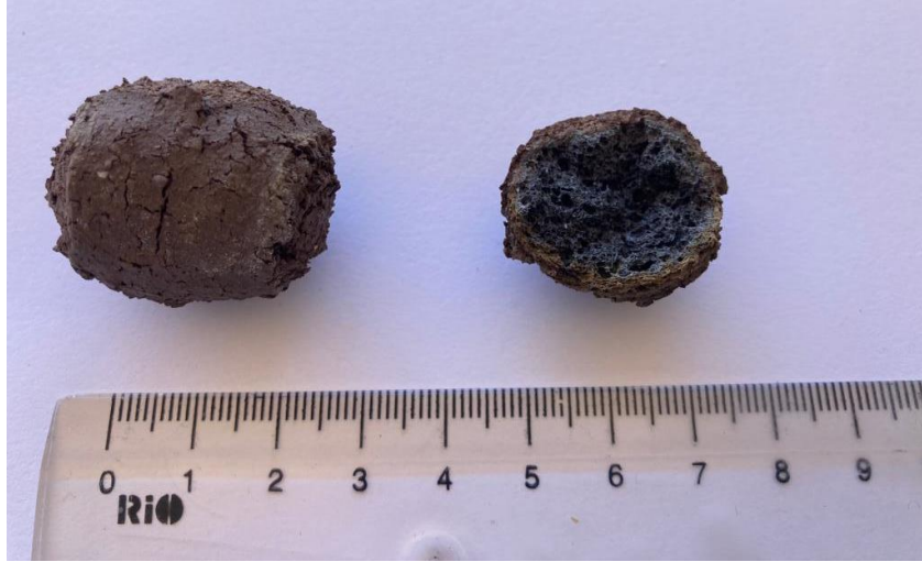
řekil 1. Genleřmiř kil agregası sinter kabuđu ve boşluklu i yapısı
