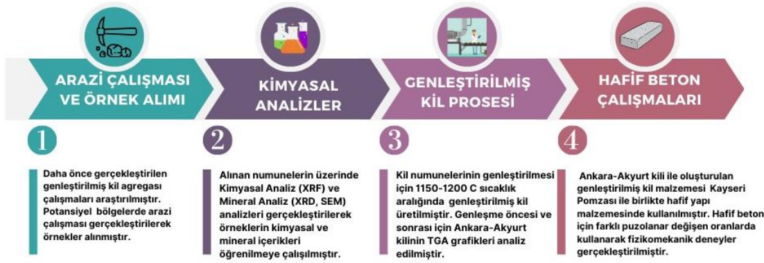
Şekil 2. Genleştirilmiş kil agregası ile oluşturulan hafif beton çalışmasının aşamaları
