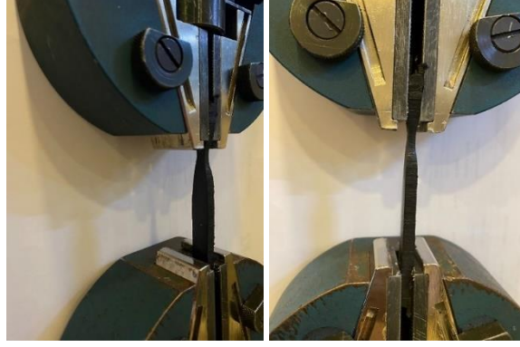
Şekil 7: Tinius Olsen Çekme Test Cihazı ve Numune
