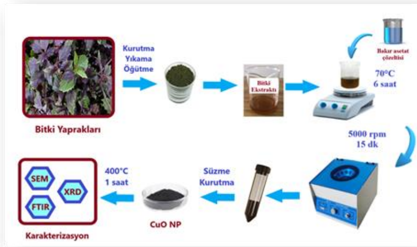
Şekil 1. CuO NP'lerin deney sürecinin şematik gösterimi.
